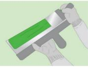
Необходимое количество шпаклевки зависит от площади обрабатываемой поверхности. Примерный расход материала указывается упаковке. Шпаклевку удобно накладывать малым шпателем на большой вдоль его кромки — так, чтобы нанести на стену за один проход. Проход выполняют размашистым крестообразным движением шпателя при среднем нажиме до выработки смеси со шпателя. Чем
