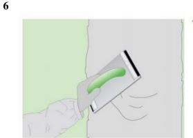
• Поверхность выравнивается повторно до достижения необходимой ровности. Под покраску наносится дополнительный финишный слой мелкодисперсной После гипсовой шпаклевки. просыхания она обрабатывается теркой с абразивной сеткой. Перед покраской или наклеиванием обоев используется мелкозернистая сетка Nº 100-120.
