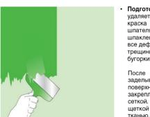
Подготовка стен. Снимается и удаляется старое покрытие: обои, краска и пр. С помощью малого шпателя и небольшого количества шпаклевки тщательно устраняются все дефекты поверхности, такие как трещины, отверстия от крепежей, бугорки и впадины.
